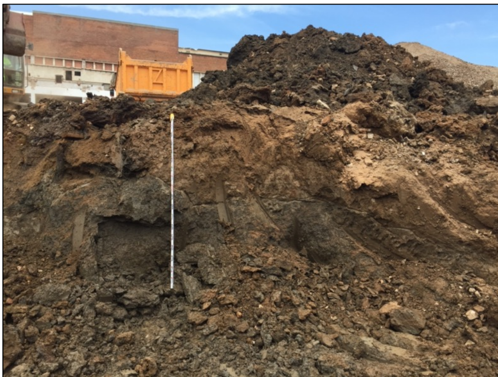
Fotografia 68. Detall terres contaminades degut als usos del solar en època contemporània.
